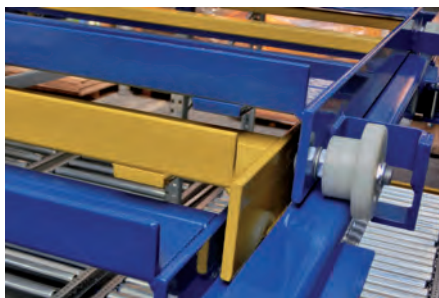
Pushfix-systemen – wagens in plaats van rollenbanen in de inschuifstelling
