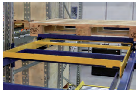
Pushfix-systemen – wagens in plaats van rollenbanen in de inschuifstelling
