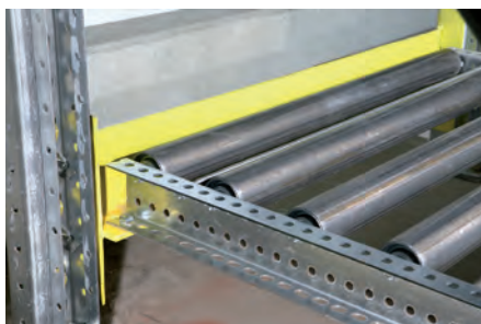
Zwaartekrachtrollenbanen – te gebruiken op de onderste etage en in de vaketages
